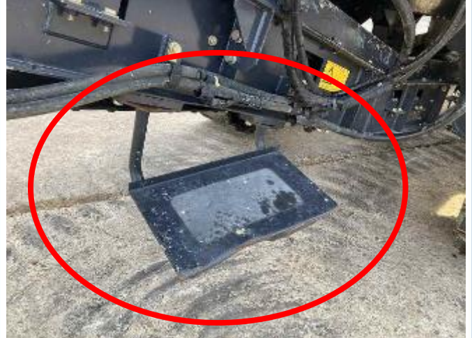
コンベアサイドステップ変形
