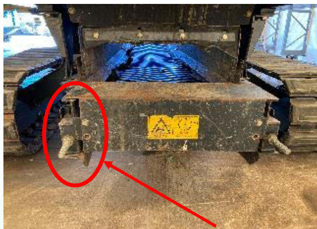
コンベアフレーム曲がり修正
