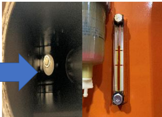
作動油交換及び油量確認
