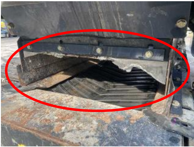
材料投下シュートゴム劣化欠損
