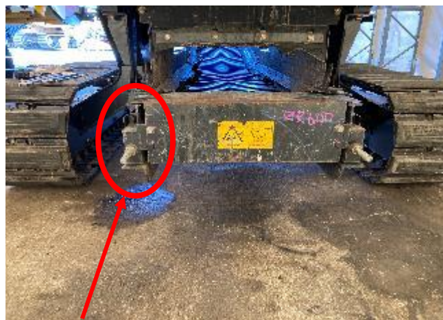
コンベアフレーム曲がり修正
