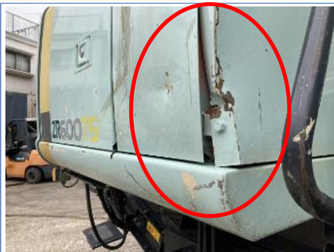
外装に変形箇所あり
