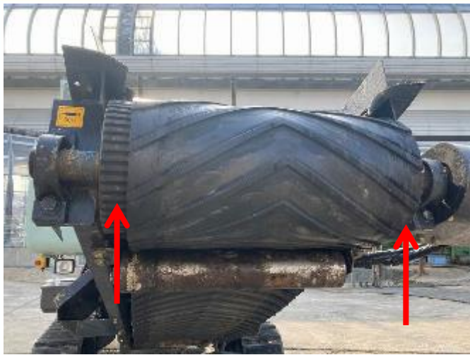
コンベアベルト先端に偏向あり
