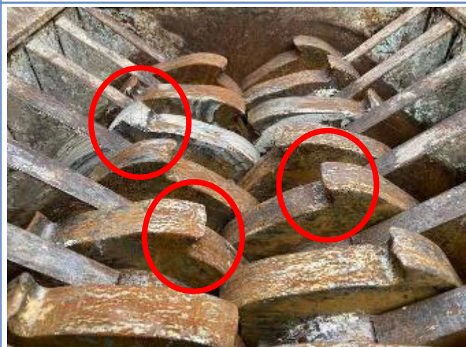
破碎刃欠け1か所、刃先全体に摩耗あり
