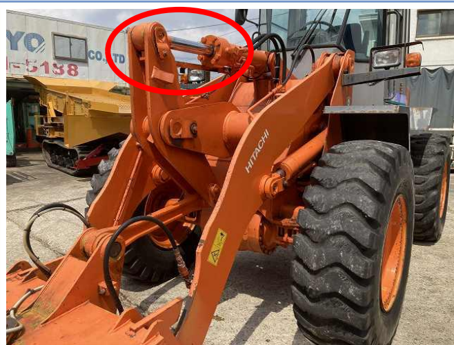
バケットシリンダー/メッキ加工、シール交換
