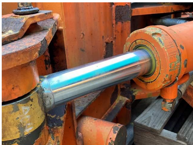
除雪ブレード 左アングルシリンダー/メッキ加工、シール交換
