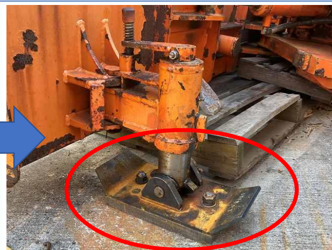
除雪ブレード 片側ソリ欠品の為、製作品取付
