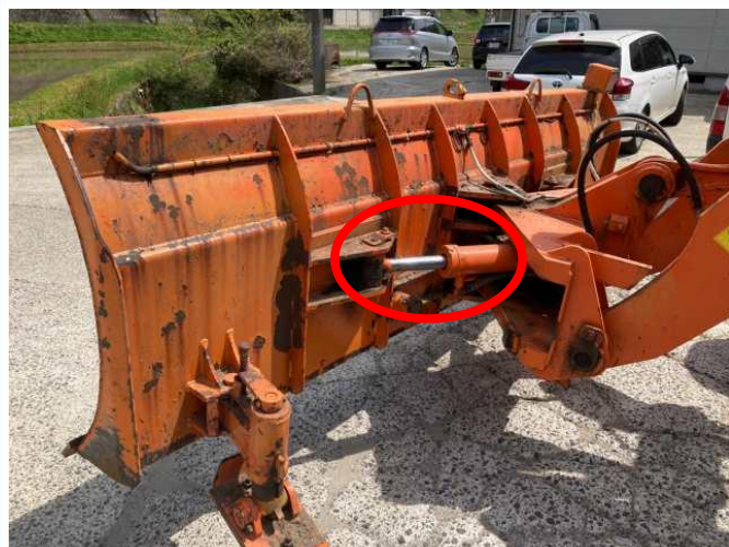
除雪ブレード 左アングルシリンダー/メッキ加工、シール交換
