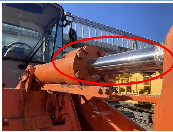
バケットシリンダー/メッキ加工、シール交換
