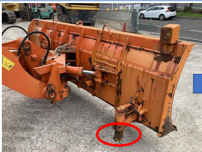
除雪ブレード 片側ソリ欠品の為、製作品取付
