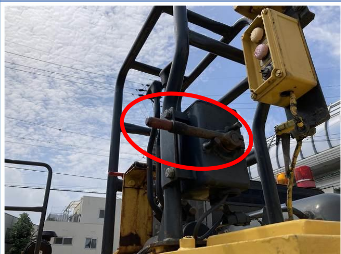
作業機安全レバー折損
