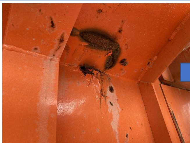
土砂ホッパー穴あきの为上側より再補強
