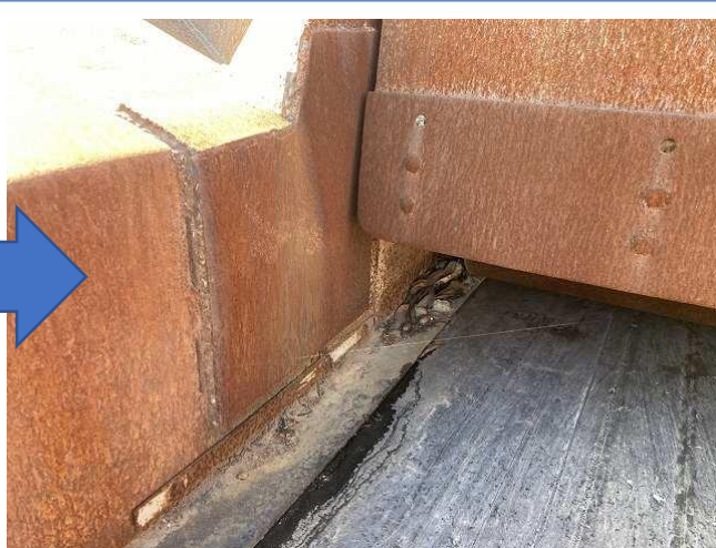
土砂ホッパー穴あきの为上側より再補強
