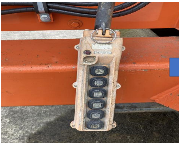
ペンダントリモコン不良の為交換
