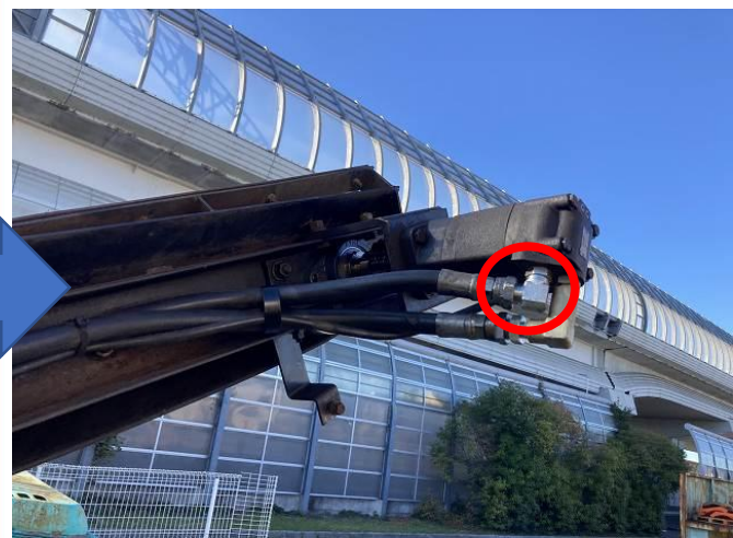
ベルコンモーター油漏れ修理、ニップル交換
