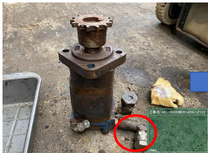
ベルコンモーター油漏れ修理、ニップル交換
