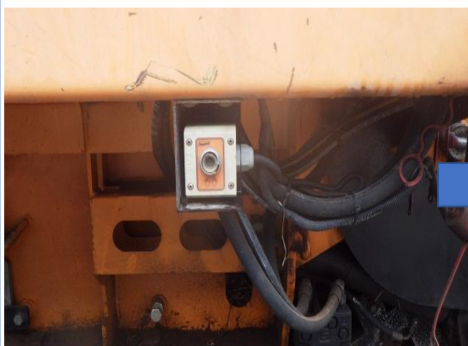
スイッチ交換(後部スイッチBOX操作 解除スイッチ)
