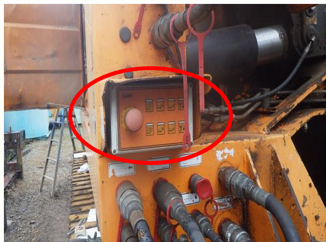
後部 スイッチBOX交換(排出コンベア格納 展開)
