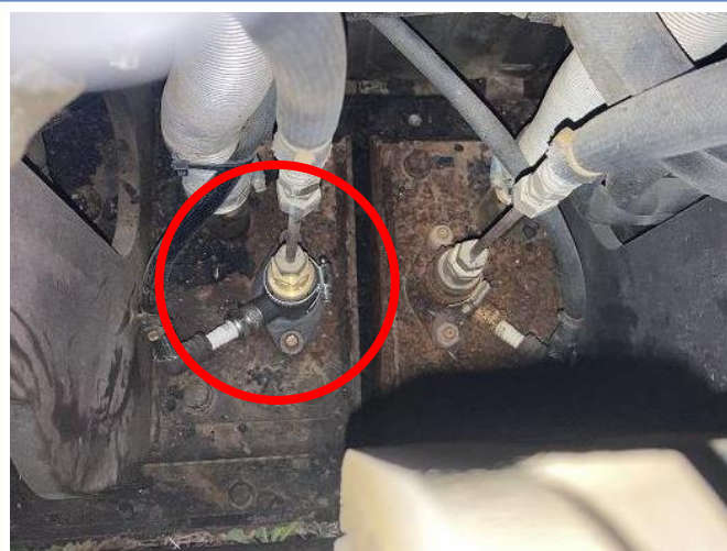
中央スクリード/右スクリード プロパンバーナー、点火プラグ交換
