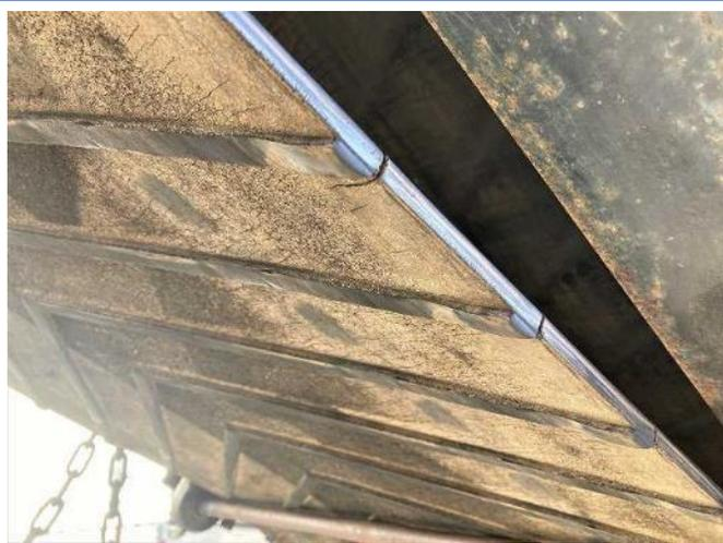
コンベアゴムサイド亀裂散見
