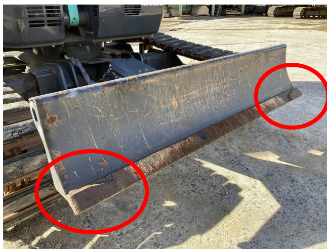
ブレード両端溶接補強
