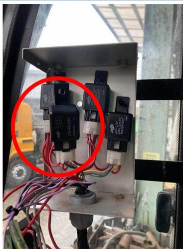
アタッチメント操作切替ボックスリレー取付
