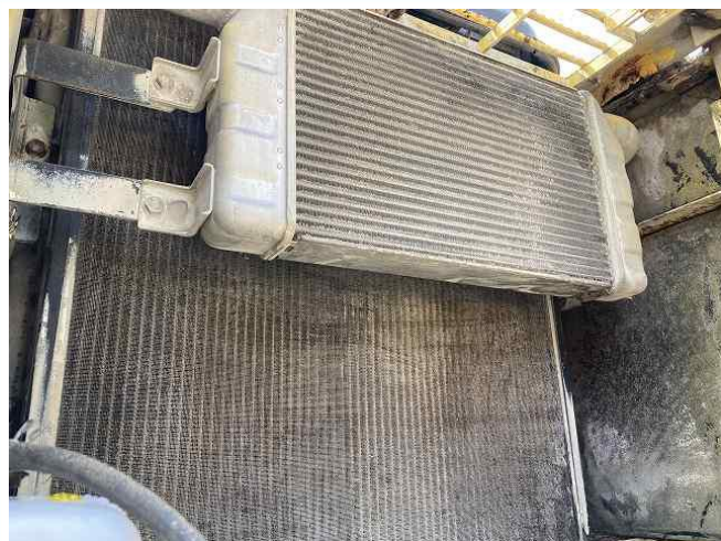
ラジエーターコア汚れ,詰まり
