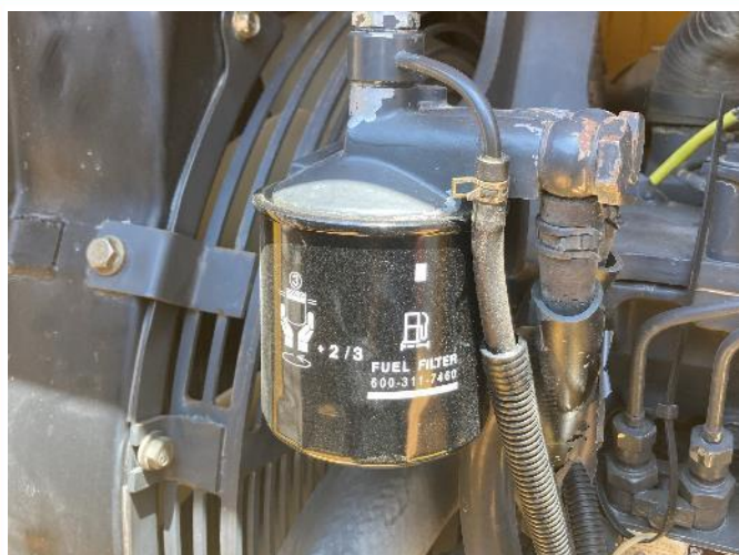
燃料エレメント交換
