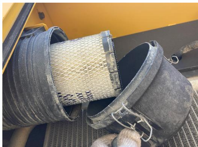
エアエレメント交換
