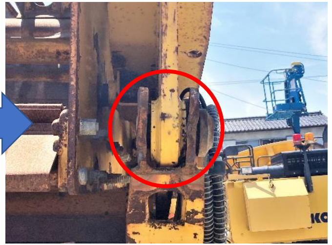
スクリーンボックス チルト支点部フレーム板金
