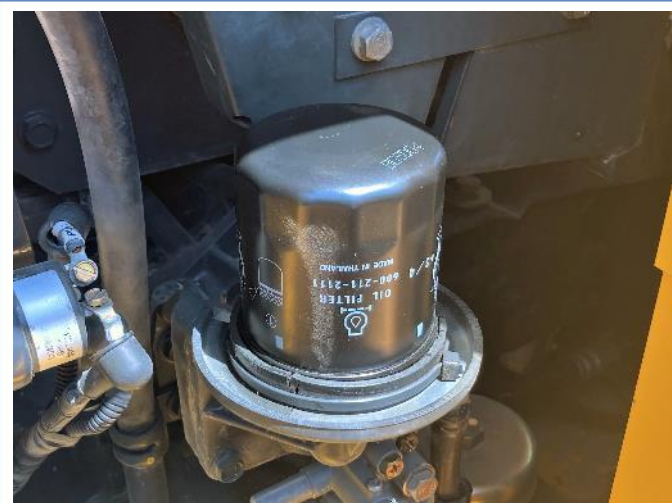
エンジンオイル及びエレメント交換
