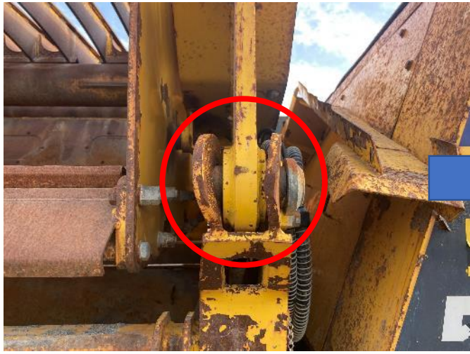
スクリーンボックス チルト支点部フレーム板金
