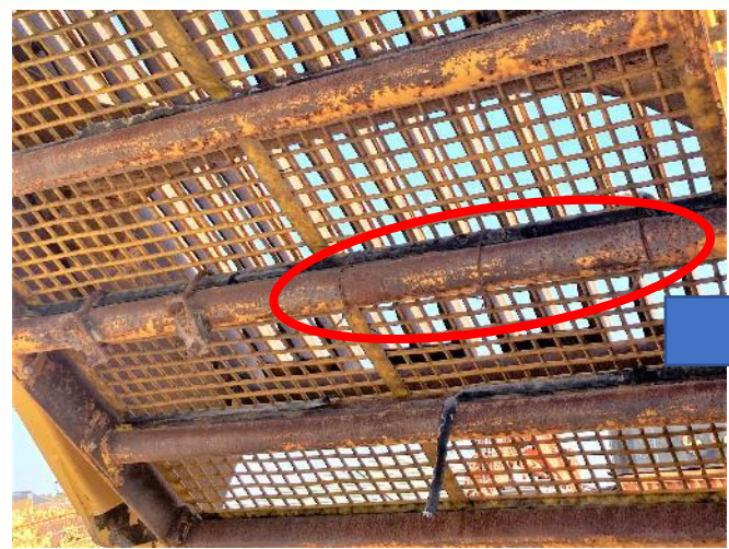
スクリーンボックス 固定Uボルト取付
