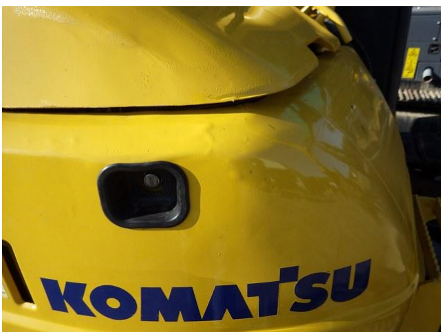
上部旋回体右側板金補修跡①
