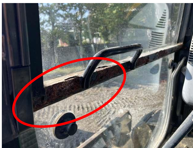
キャブ内側サッシ錆び
