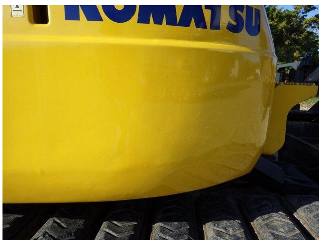
上部旋回体右側板金補修跡②
