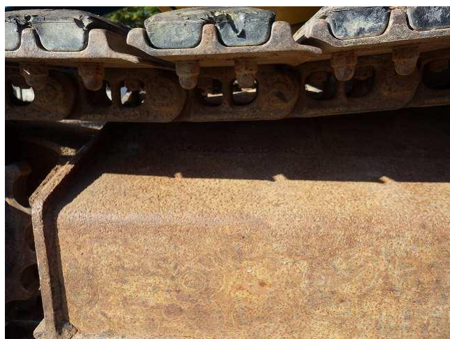
トラックフレーム右側錆び
