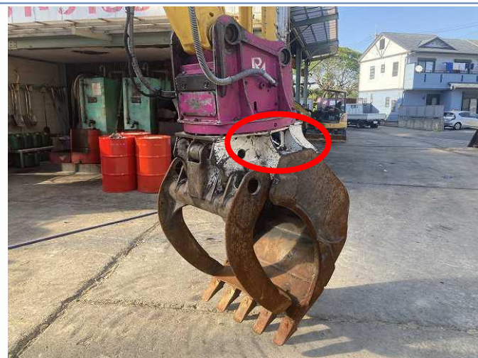
溶接補修跡 ①
