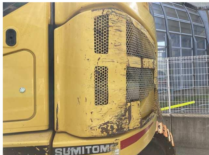
外装カバー変形 ドアキャッチ破損 ④
