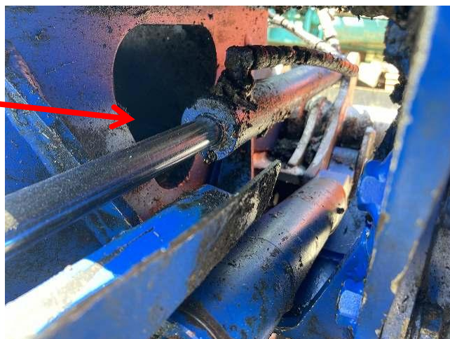
カッター開閉シリンダー油漏れ
