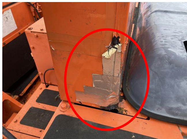
操作盤外装 一部破損
