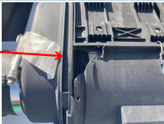
エアークリーナーケース破損②
