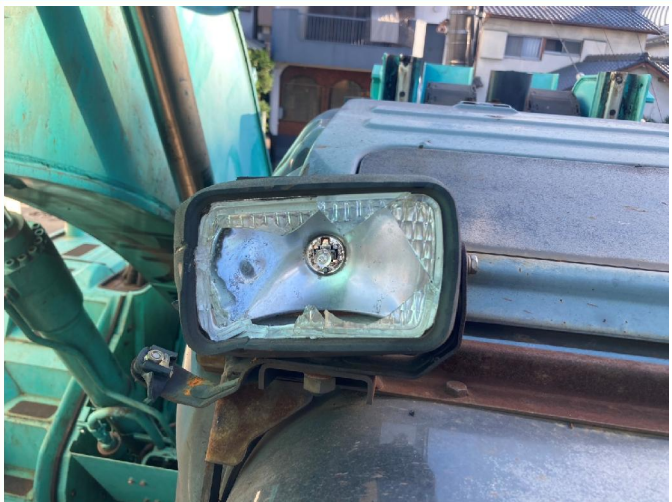
CAB上作業灯レンズ割れ
