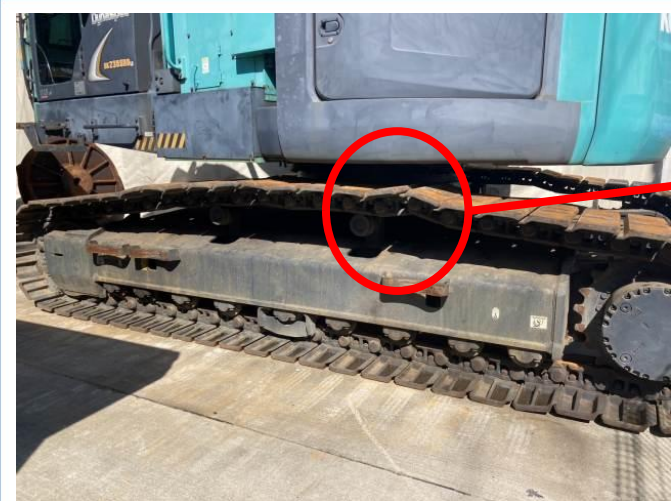
シューリンク固着①
