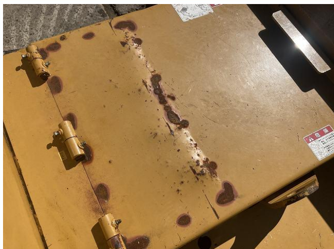
破砕室上部カバー膨らみ
