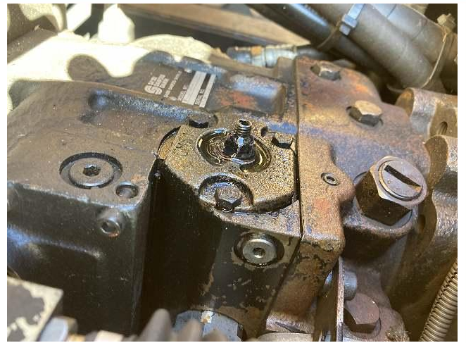
HSTポンプバルブ油もれ
