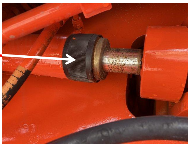
出口調整シリンダーロッド錆②
