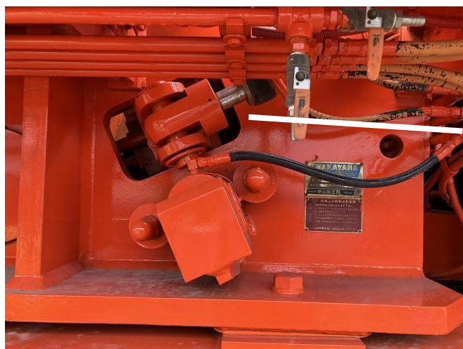
出口調整シリンダーロッド錆①
