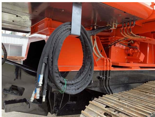
外部駆動油圧ホース取付け
