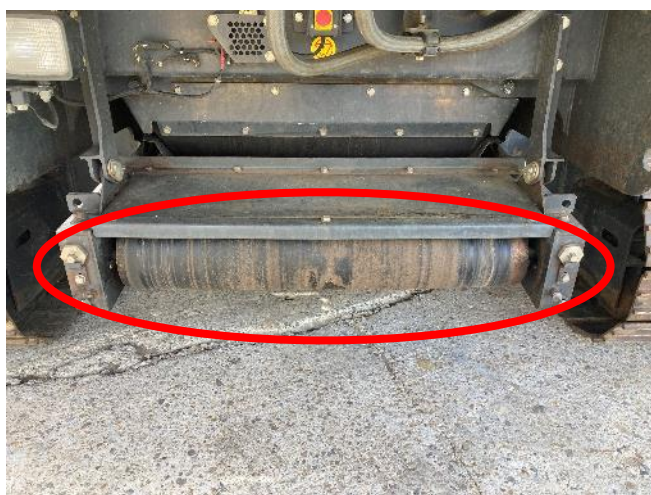
コンベアテール側外装カバー欠損
