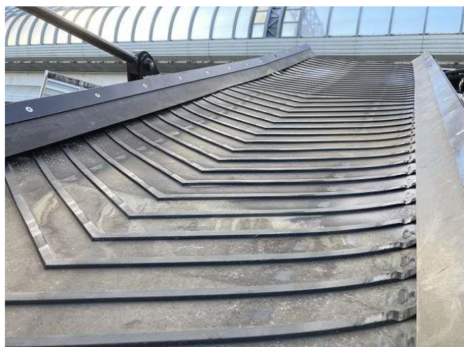
排出コンベアベルト・サイドラバー、押えローラー交換(2022年7月)
