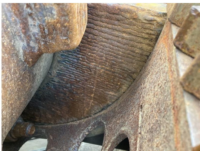
破砕室側壁(コンベア側)溶接補修
