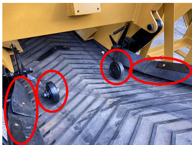
排出コンベアベルト・サイドラバー、押えローラー交換(2022年7月)
