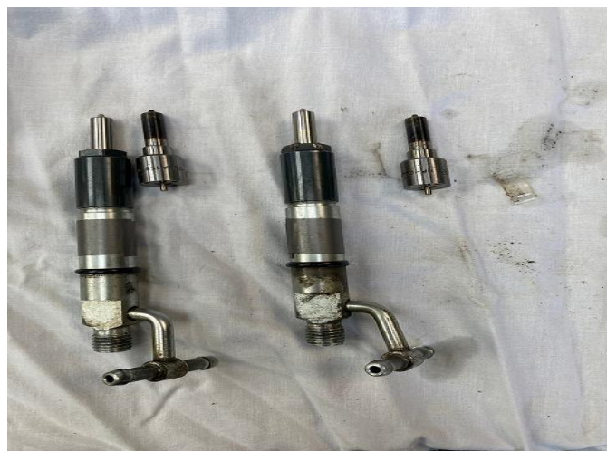
エンジンノズル不良のため交換(2本)
