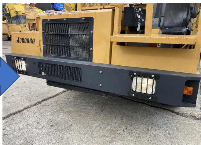
フロントバンパー、ライト類欠損のため取付
