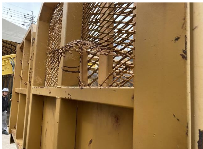
ベッセル前方煽り網破損
