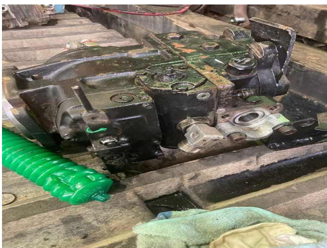
HSTポンプ油漏れのため脱着修理
