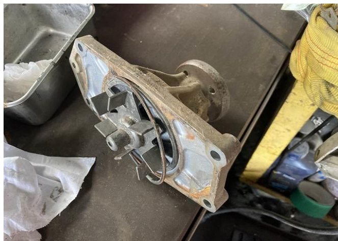
ウォーターポンプ水漏れのため交換
