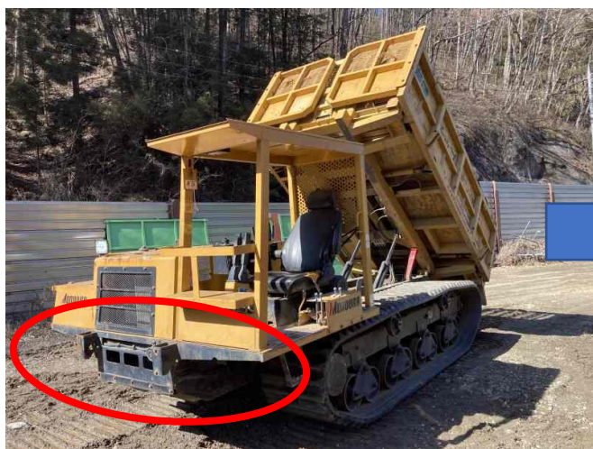
フロントバンパー、ライト類欠損のため取付
