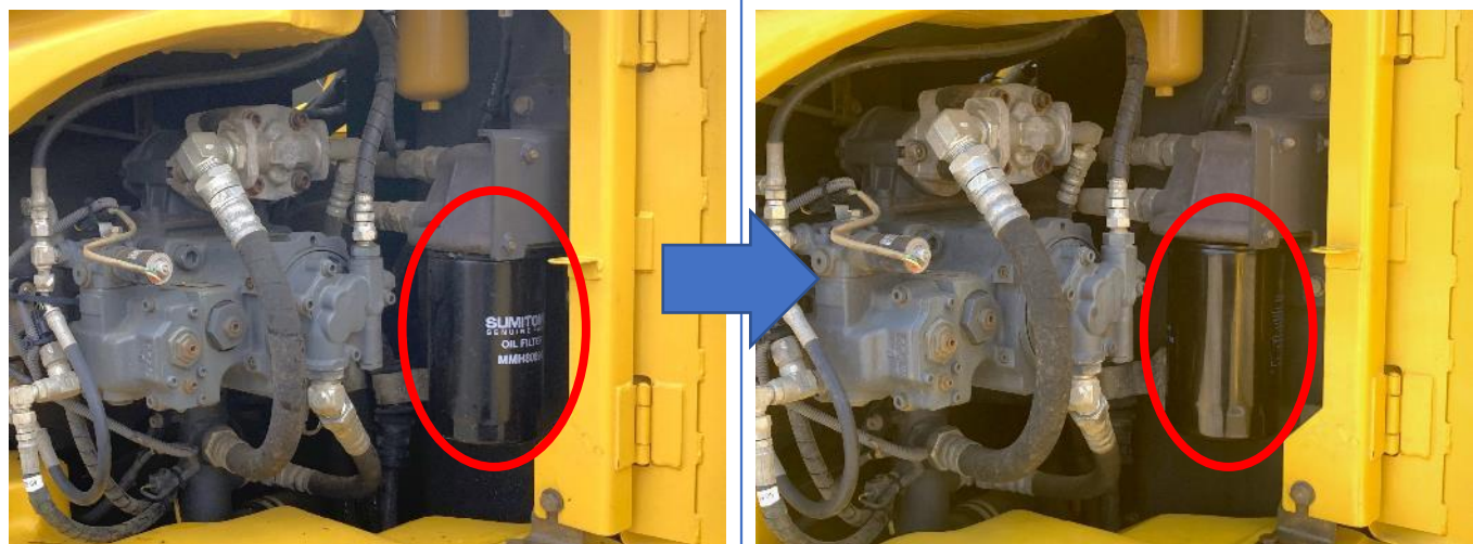
エンジンオイル及びエレメント 交換
