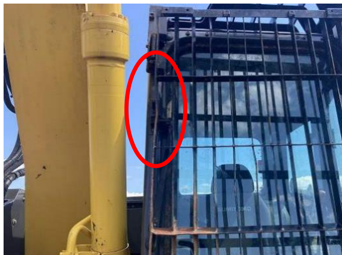
CABフロントガード変形
