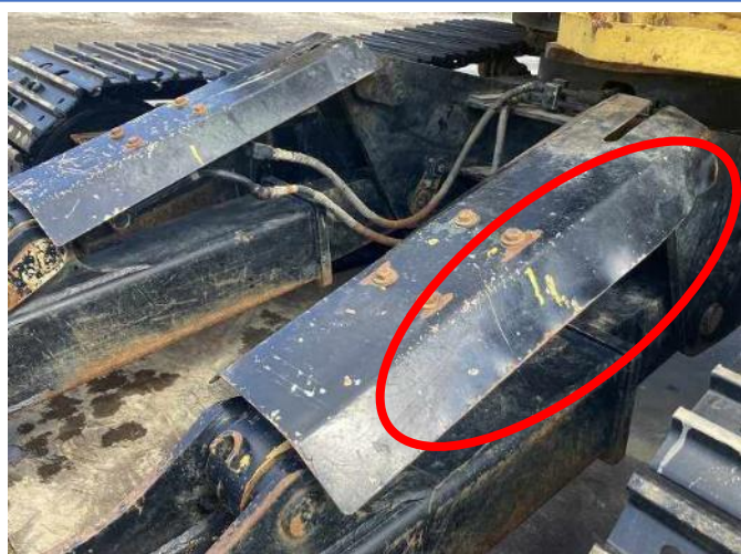
排土板シリンダーガード変形
