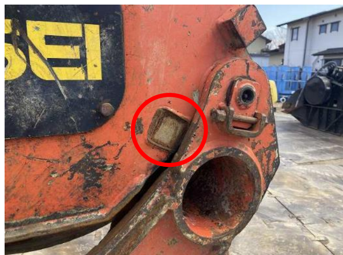
グラップル閉側エンドストッパー欠損
