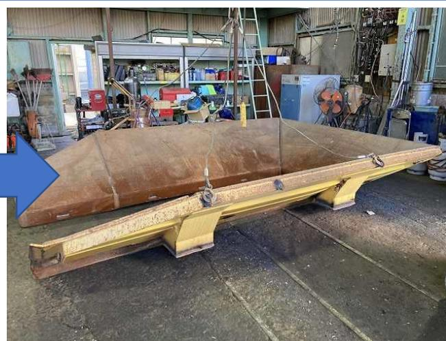
投入ホッパー台座フレーム改造の為補修、ボルト固定
