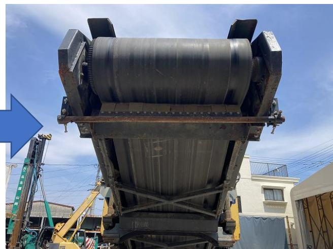
ベルコン先端カバーフレーム変形の為板金修理
