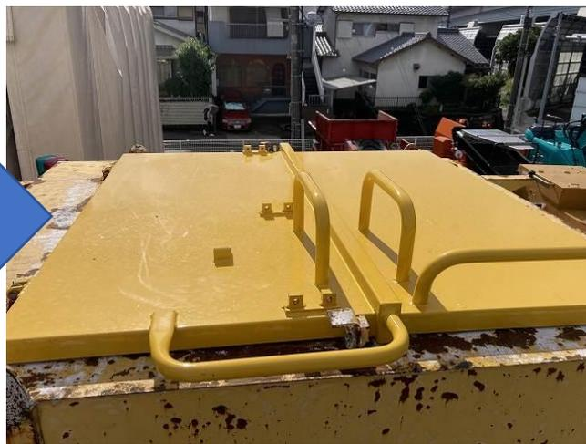
ホッパー上部カバー破損の為交換
