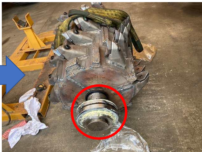
破砕ドラムベアリング両側交換
