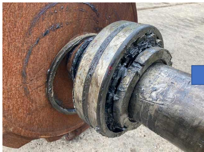
破砕ドラムベアリング両側交換
