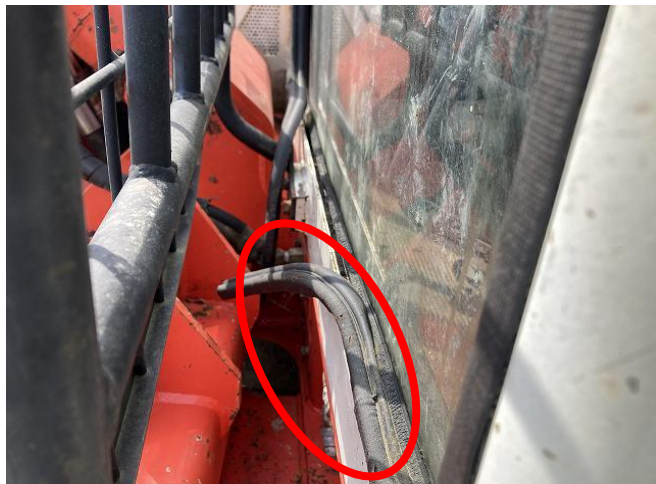
フロントガラスパッキン不良
