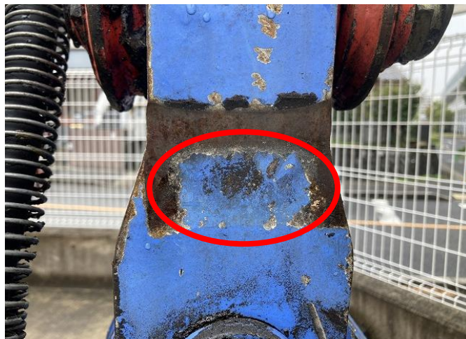
アタッチメント銘板欠損
