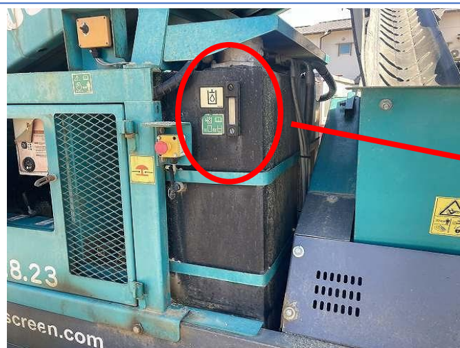
作動油ゲージ劣化のため視認不良
