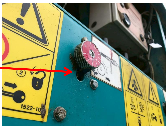
オーバーコンベアスピードダイヤル油漏れ
