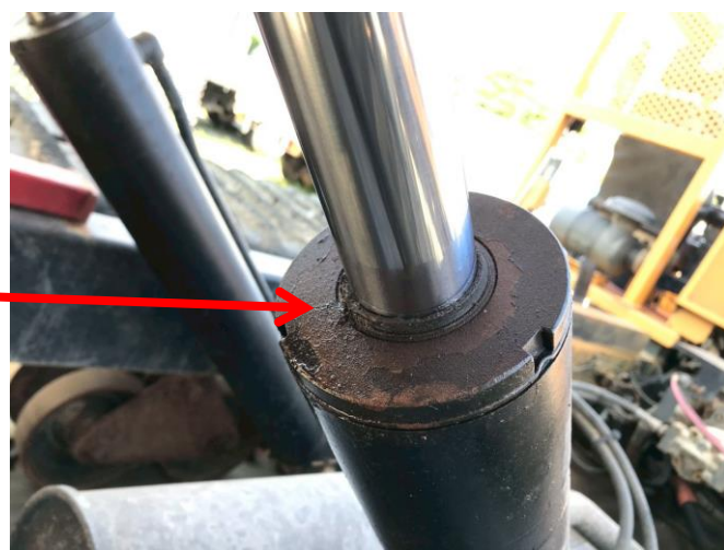
ダンプシリンダー油漏れ②(右側)
