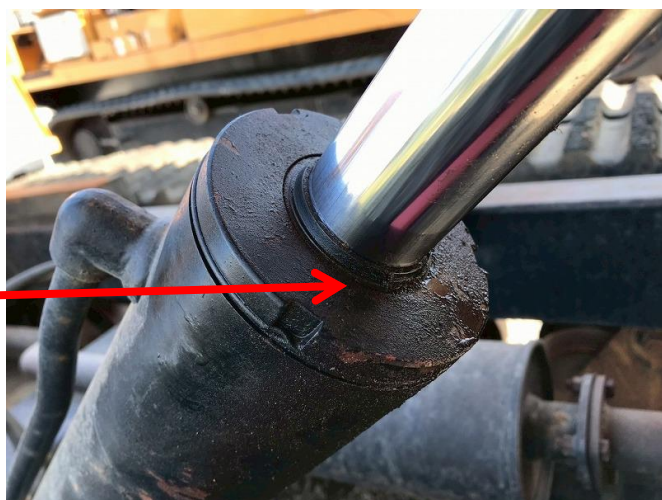
ダンプシリンダー油漏れ①(左側)
