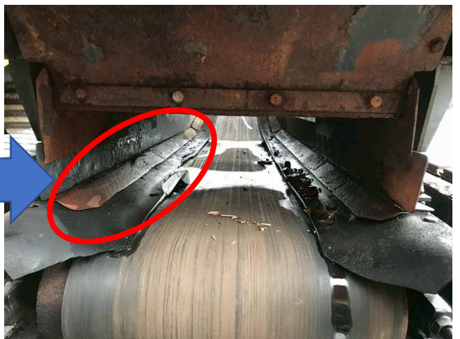
コンベアガイドプレート破損修理
