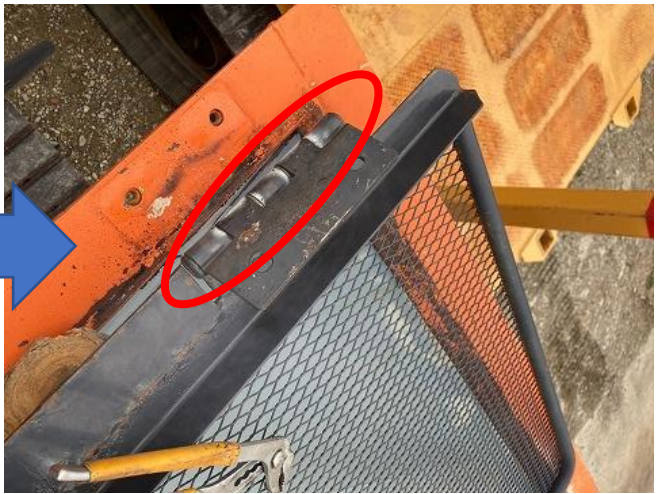
飛散防止ガードヒンジ固着修正
