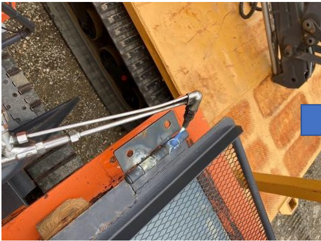
飛散防止ガードヒンジ固着修正
