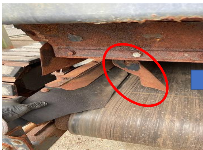
コンベアガイドプレート破損修理
