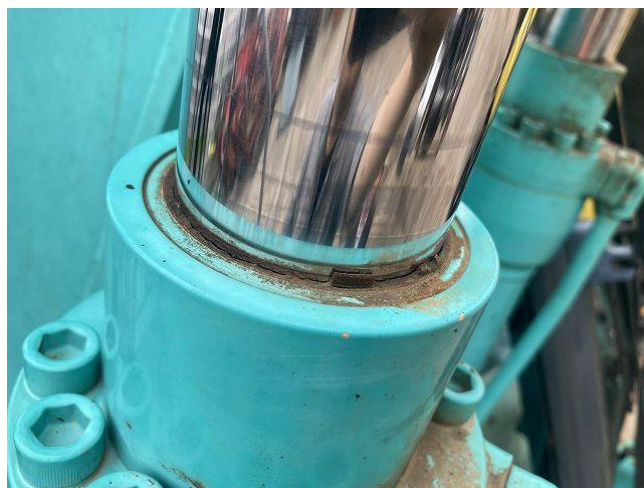
ブームシリンダシール劣化(漏れなし)
