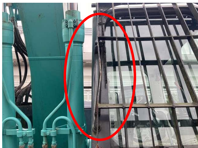
フロントガードの一部変形
