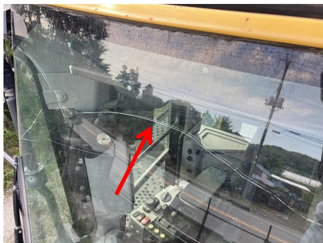
フロントガラスひび割れ
