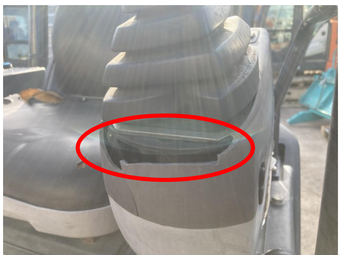
操作レバーコンソール割れ
