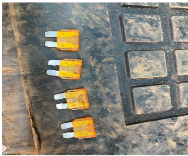
パーキングブレーキ作動不良、フューズ交換にて解決
