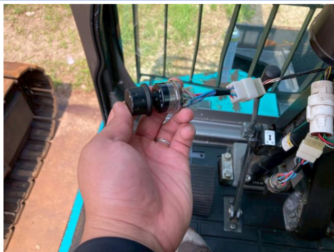
パーキングブレーキ作動不良、フューズ交換にて解決
