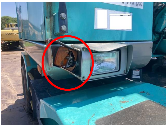
右前方ウィンカーレンズ破損(点灯OK)
