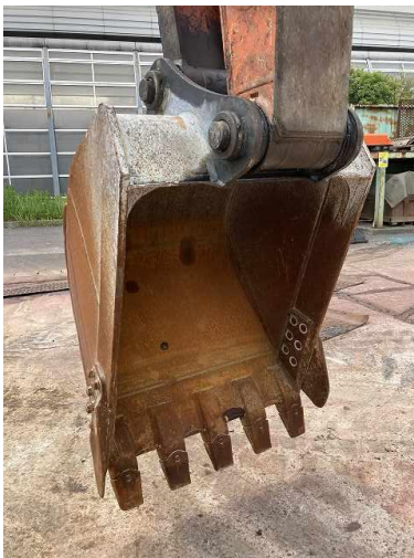
バケットリンクピン交換、バケットピン、ブッシュ、ツース交換
