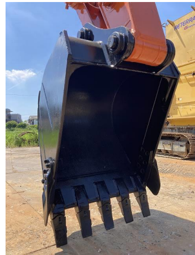
バケットリンクピン交換、バケットピン、ブッシュ、ツース交換
