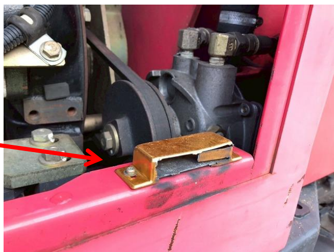
エンジンフードカバー留め具破損①
