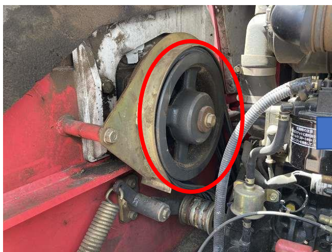
破碎ドラムベアリング交換
