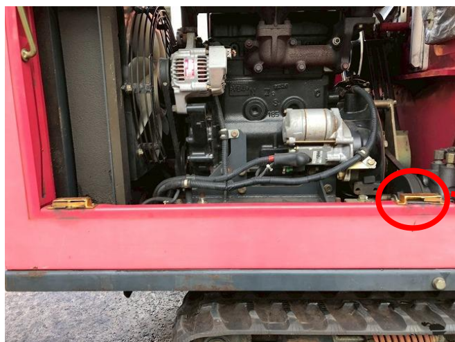
エンジンフードカバー留め具破損①
