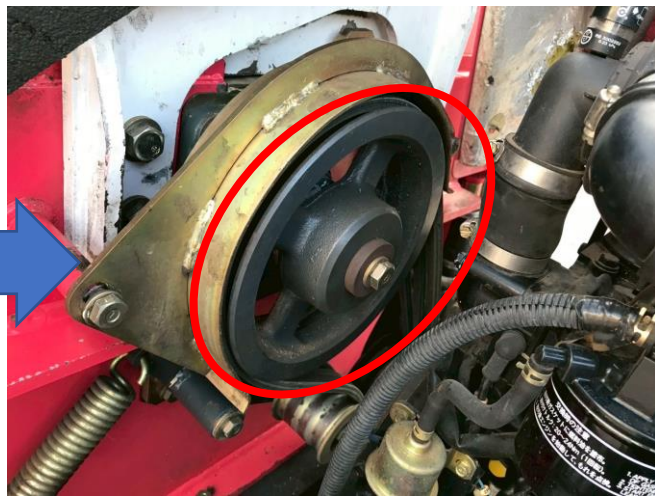
破碎ドラムベアリング交換
