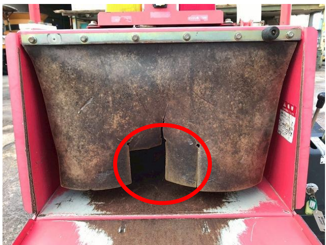
投入口飛散防止カバー破れ
