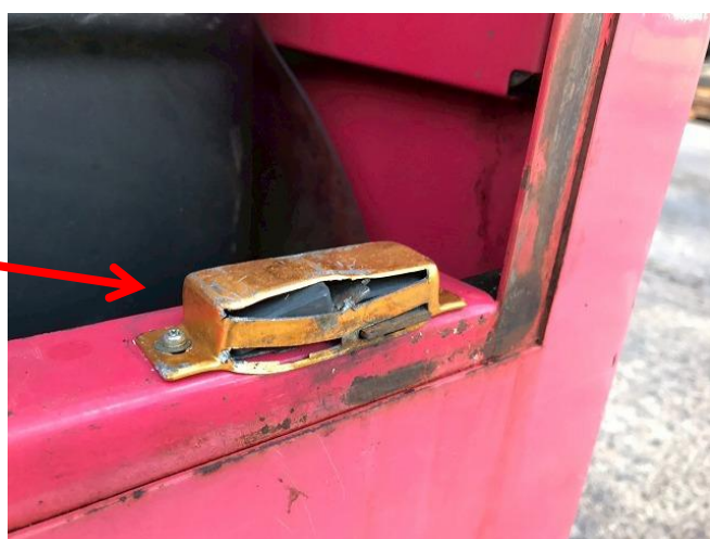
エンジンフードカバー留め具破損②
