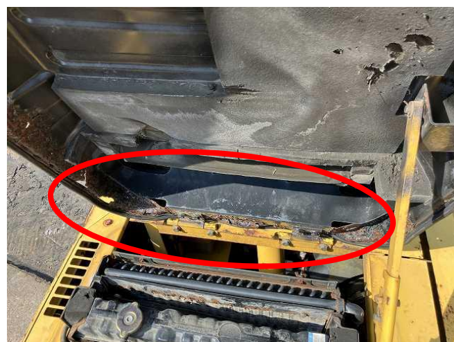
外装カバー錆腐蝕あり①(EGフード)
