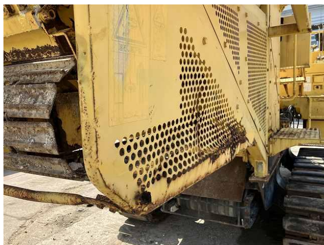
フィーダ下サイドカバー凹み変形①
