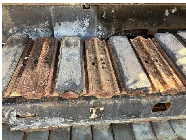
足回りゴムPAD 脱落散見
