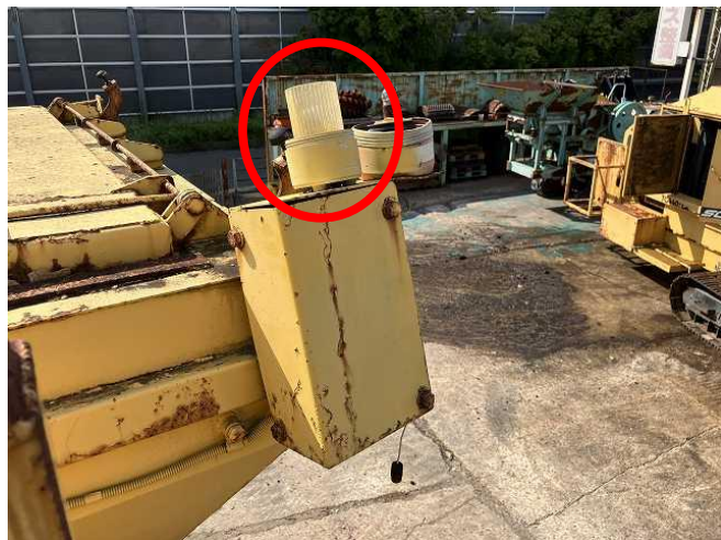
固化剤ホッパー回転灯破損
