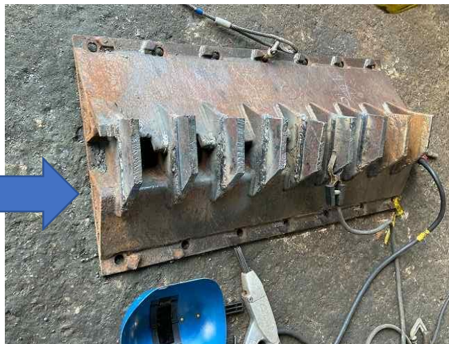
サイドコーム偏摩耗部補修(2024年10月作業)
