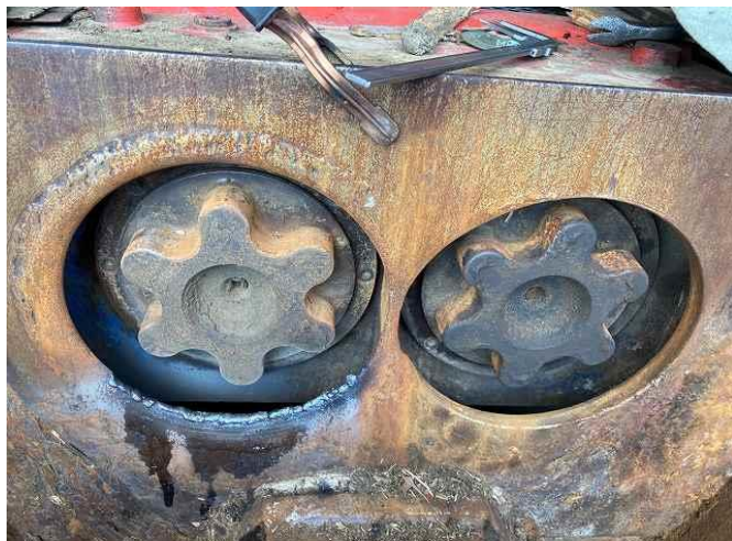
クローバーカップリング溶接肉盛り(2024年10月作業)
