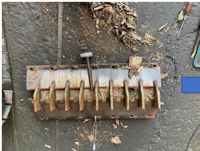
サイドコーム偏摩耗部補修(2024年10月作業)
