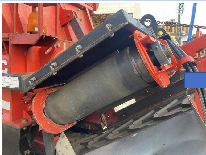
磁選機コンベアベルト交換(2024年10月作業)
