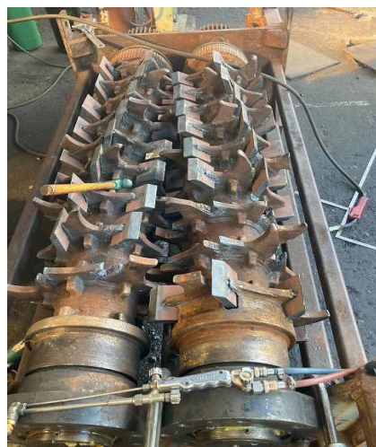
破砕シャフトベアリング両側交換(2024年10月作業)
