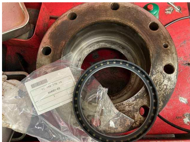
破砕シャフトベアリング両側交換(2024年10月作業)
