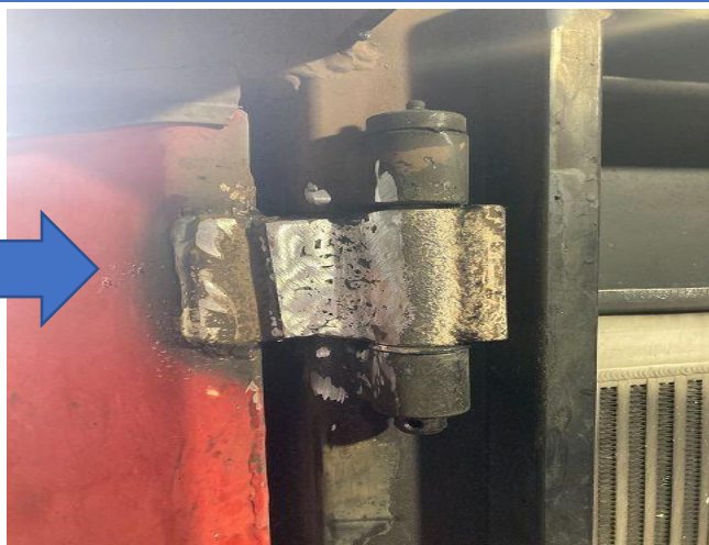
燃料タンク蝶番破損部修正(2024年10月作業)
