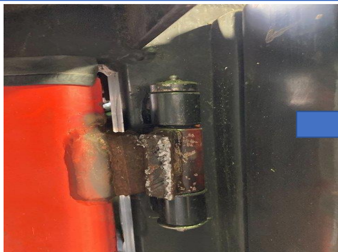
燃料タンク蝶番破損部修正(2024年10月作業)
