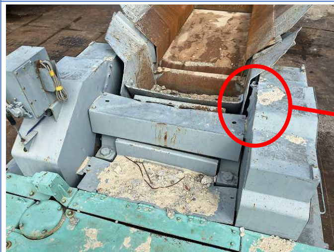
クラッシャーフライホイールカバー凹み破損
