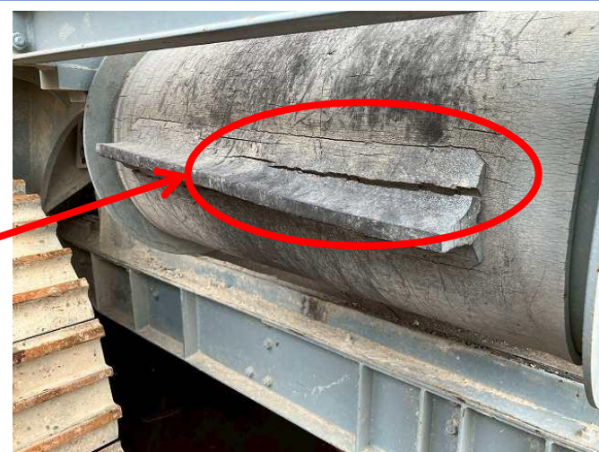
磁選機コンベアベルトラグ亀裂散見
