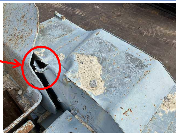
クラッシャーフライホイールカバー凹み破損
