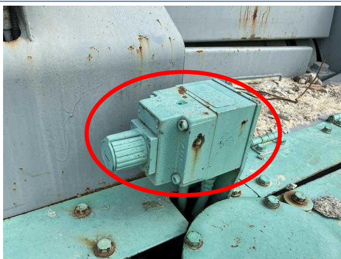
フィーダー速度ダイヤル固着(回らない)
