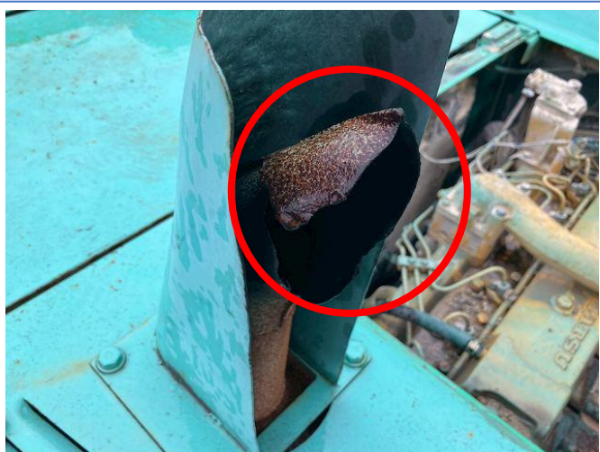
マフラーパイプ破れ、排気漏れ
