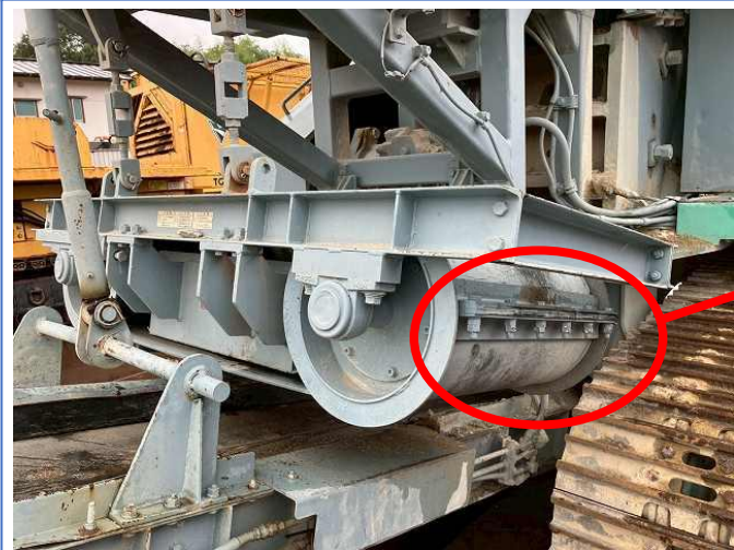
磁選機コンベアベルトラグ亀裂散見
