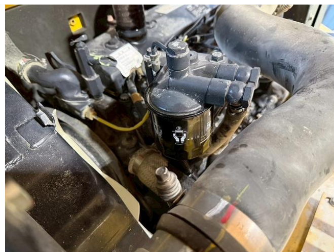
燃料エレメント交換
