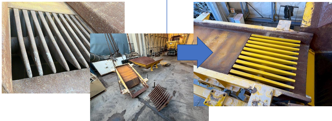
ホッパーフレーム修正/グリズリ交換(製作品)
