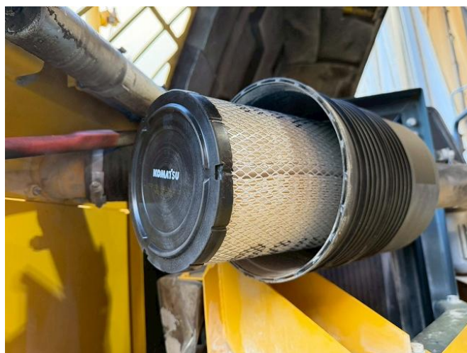
エアエレメント交換
