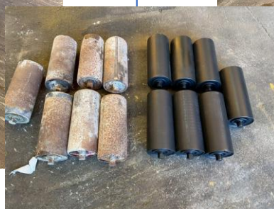
排出コンベアインナーローラー交換(10個)
