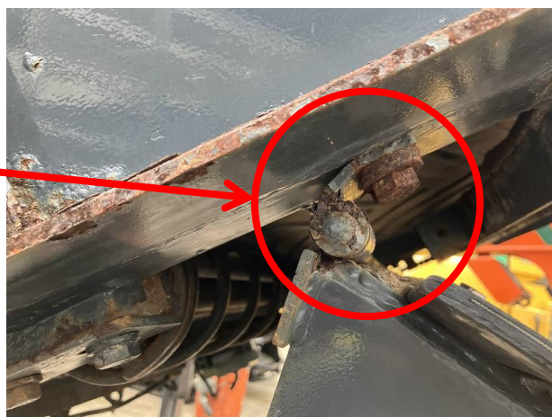
コンベアアンダーローラーカバーのヒンジ曲がりのため閉まらない
