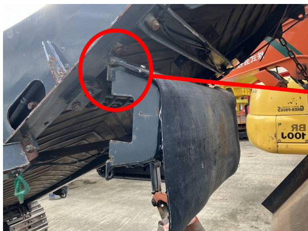
コンベアアンダーローラーカバーのヒンジ曲がりのため閉まらない
