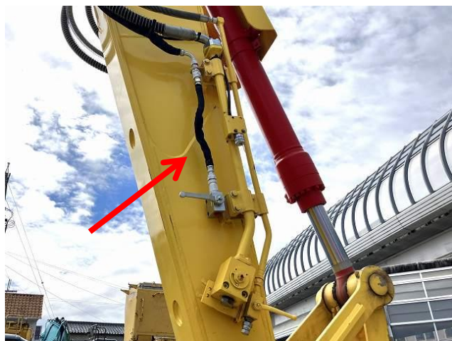
全旋回用配管設置
