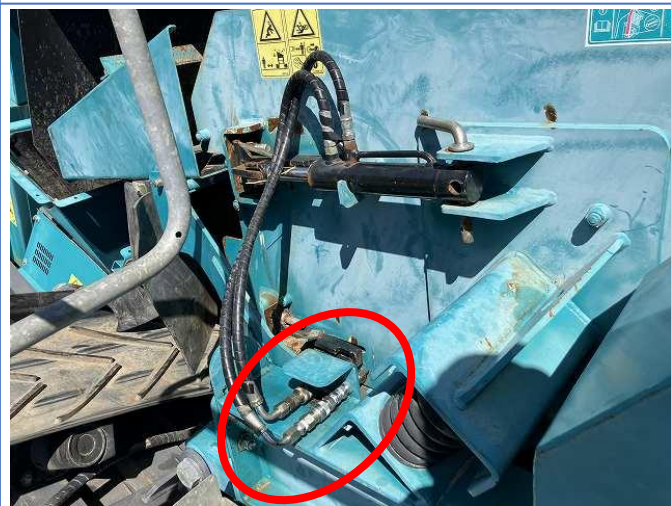
スクリーン張り調整シリンダアダプタ交換
