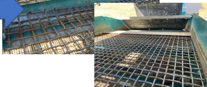
上段スクリーン欠損のため新品取り付け(織網□40mm)
