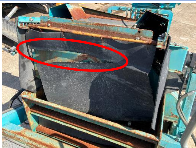
スクリーンボックス ゴム垂れ破損
