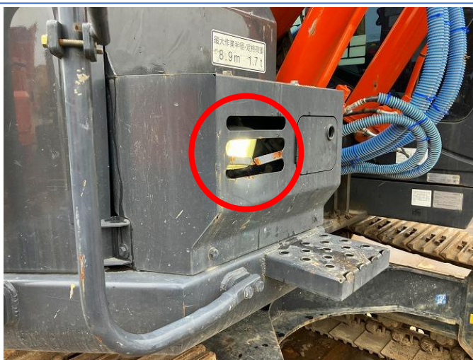
フロントライトカバー破損 ①
