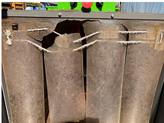
投入口カーテン破損(補修済)
