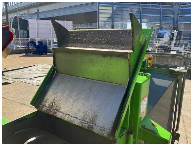
破砕室カバー汚れ
