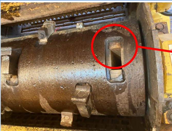
デュープレックスドラムカッターブロックシート摩耗の為肉盛り
