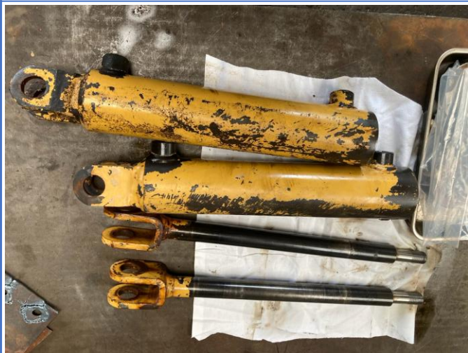
飛散防止カバー両側シリンダーO/H②
