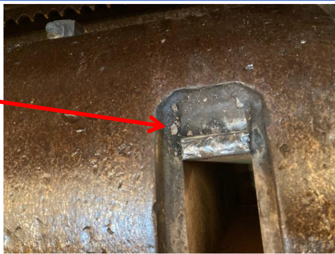
デュープレックスドラムカッターブロックシート摩耗の為肉盛り
