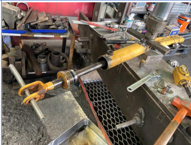
飛散防止カバー両側シリンダーO/H①
