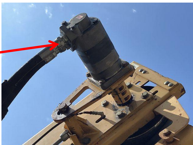
排出コンベアモーター交換
