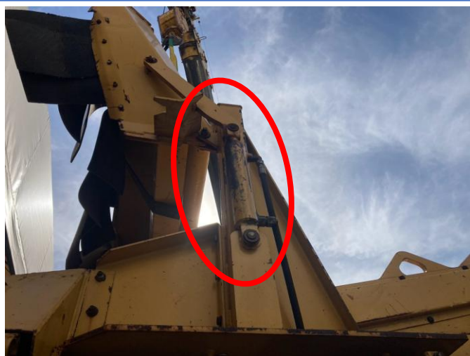
飛散防止カバー両側シリンダーO/H①
