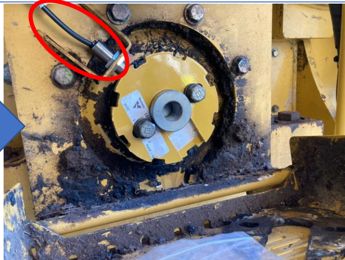
ハンマーミル回転測定プレートがたつきの為交換、回転センサー交換
