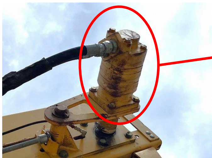
排出コンベアモーター交換
