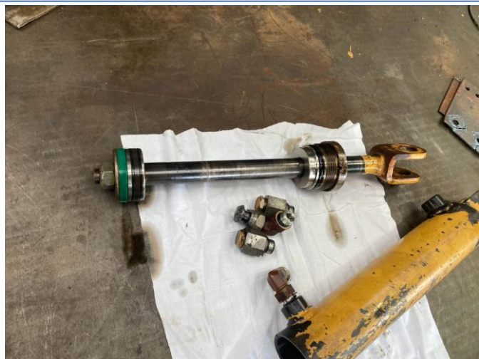
飛散防止カバー両側シリンダーO/H②
