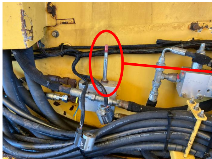
飛散防止カバー不動の為ソレノイド交換
