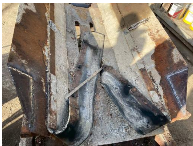
コンベアサイドゴム脱着交換
