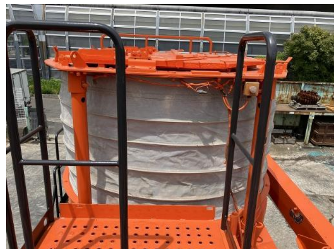
固化材フィーダーシート下方パッチ補強
