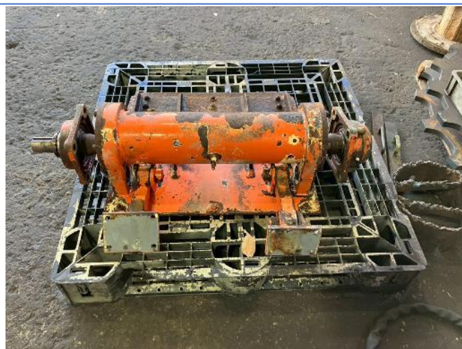
揺動ゲート脱着点検
