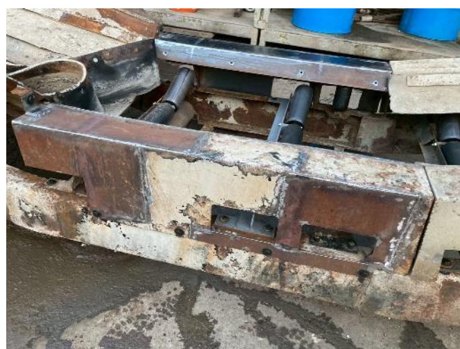
フレーム腐食部溶接補修
