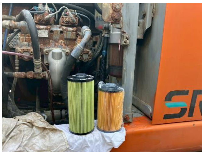
燃料エレメント交換
