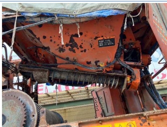
固化材フィーダーカバー脱着清掃
