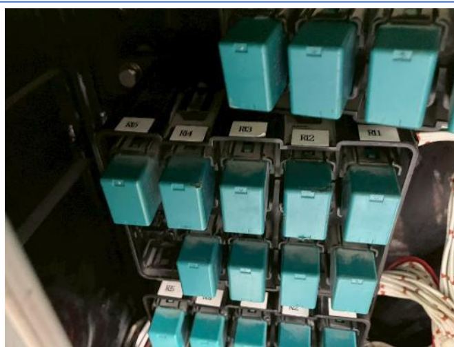
各部配線、電子機器類点検し不良リレー交換、配線腐食部修理
